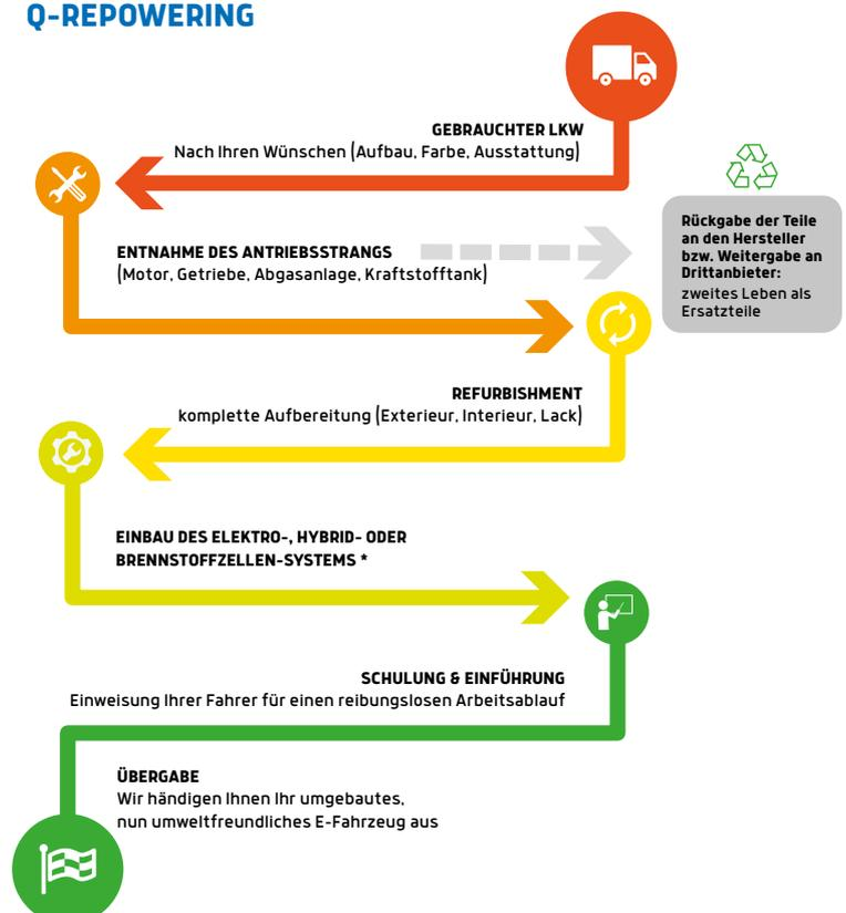
\*Je nach Antriebsart werden die entsprechenden Komponenten wie E-Motor, Batterien, Leistungselektronik, Brennstoffzelle, Wasserstofftanks installiert
