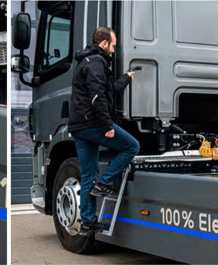
Spezielle Aufstiegsleiter für E-Sattelzugmaschinen
