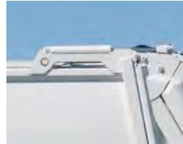
**4** Heckteilzylinder auf dem Dach
